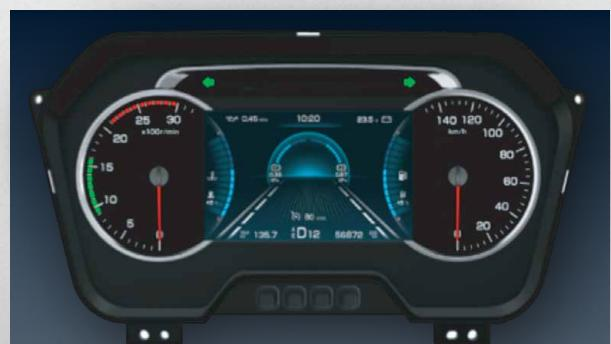
Многофункциональный жидкокристаллический дисплей имеет антибликовую регулировку.
