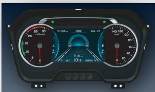
Многофункциональный жидкокристаллический дисплей имеет антибликовую регулировку.
